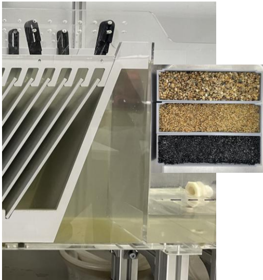
Layer 1: Gravel Layer 2: Sand Layer 3: Anthracite
